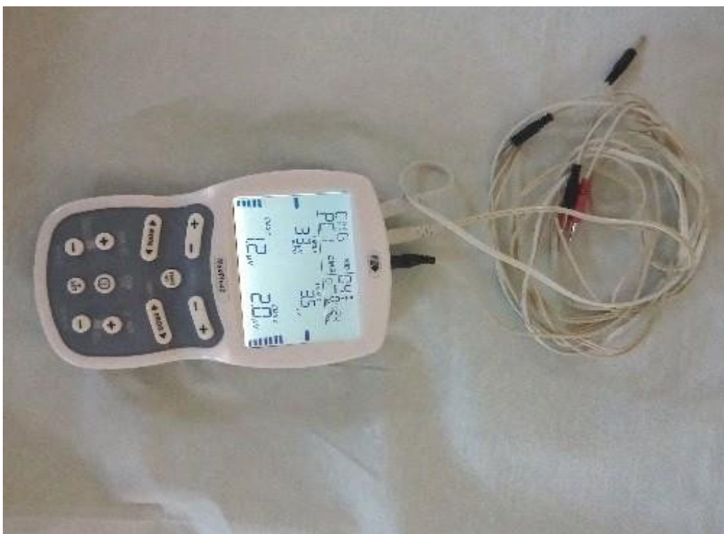
Rycina 6. Urządzenie Neuro Trac MyoPlus 2 firmy Verity Medical Ltd wykorzystywane do przeprowadzania badania powierzchniowego-EMG mięśni dna miednicy.
